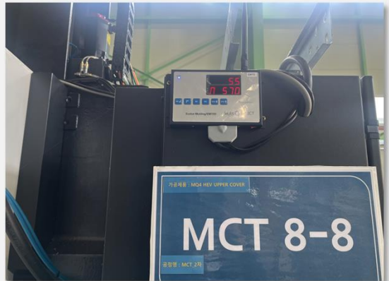
생산설비에서 Device가 카운터 및 가동정보를 수집 및 무선 송신
