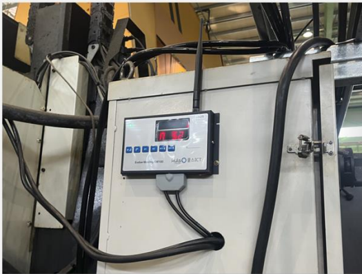
생산설비에서 Device가 카운터 및 가동정보를 수집 및 무선 송신
